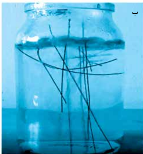
▲ شکل ۱. آ. نمایی از سیم‌های حافظه‌دار مجاله‌شده و ب. بازیابی شکل اولیه سیم‌های حافظه‌دار با فرو بردن آن‌ها در آب گرم.
