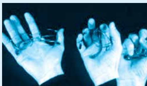
▲ شکل ۱۰ نمایش قابلیت بازیابی شکل اولیه در قاب عینک خم‌شده که از آلیاژ حافظه‌دار نیتینول ساخته شده است.
