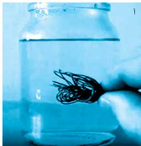
▲ شکل ۱. آ. نمایی از سیم‌های حافظه‌دار مجاله‌شده و ب. بازیابی شکل اولیه سیم‌های حافظه‌دار با فرو بردن آن‌ها در آب گرم.
